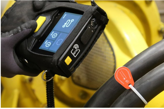
RFID 读取模块无接触地检测应答器的编码。
